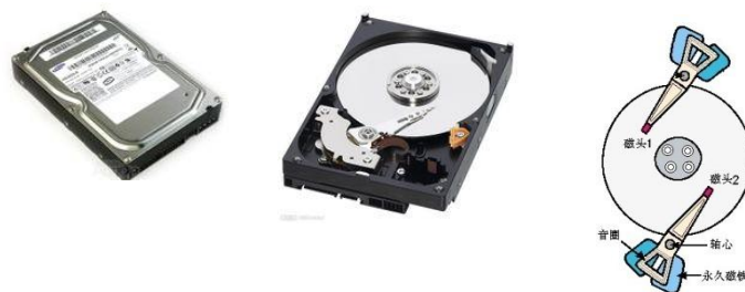
(a)外观 (b)内部 (c)存取原理示意图
