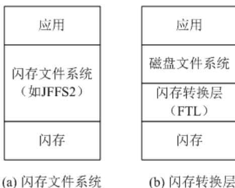
图[FTL-JFFS-comparison] 闪存转换层和闪存文件系统的工作方式区别
