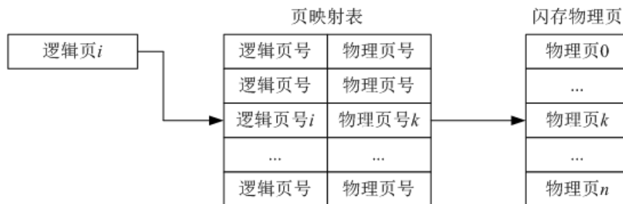
图[FTL-page-mapping] 页级别映射示意图
