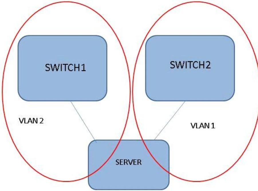
这种模式适用于如下拓扑，两个接口分别接入两台交换机，并且属于不同的vlan，当一边的网络出现故障不会影响服务器另一边接入的网络正常工作。而且故障过程是0丢包。下面展示了这种模式下ping信息：
