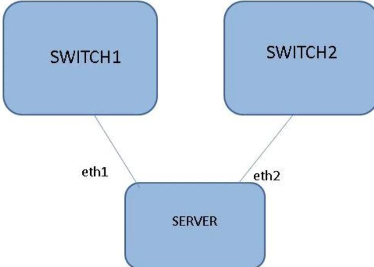
如上图，设备开始时会发送免费arp，以主端口eth1的mac为源，当客户端收到这个arp时就会在arp缓存中记录下这个mac对的ip。而在这个模式下，服务器每个端口在ping操作时，会根据算法算出出口，地址不断变化时他，这时会负载到不同端口。实验中ping1.1.1.3时往eth2发送，源mac为00:D0:F8:00:0C:0C，ping1.1.1.4是往eth1发送，
